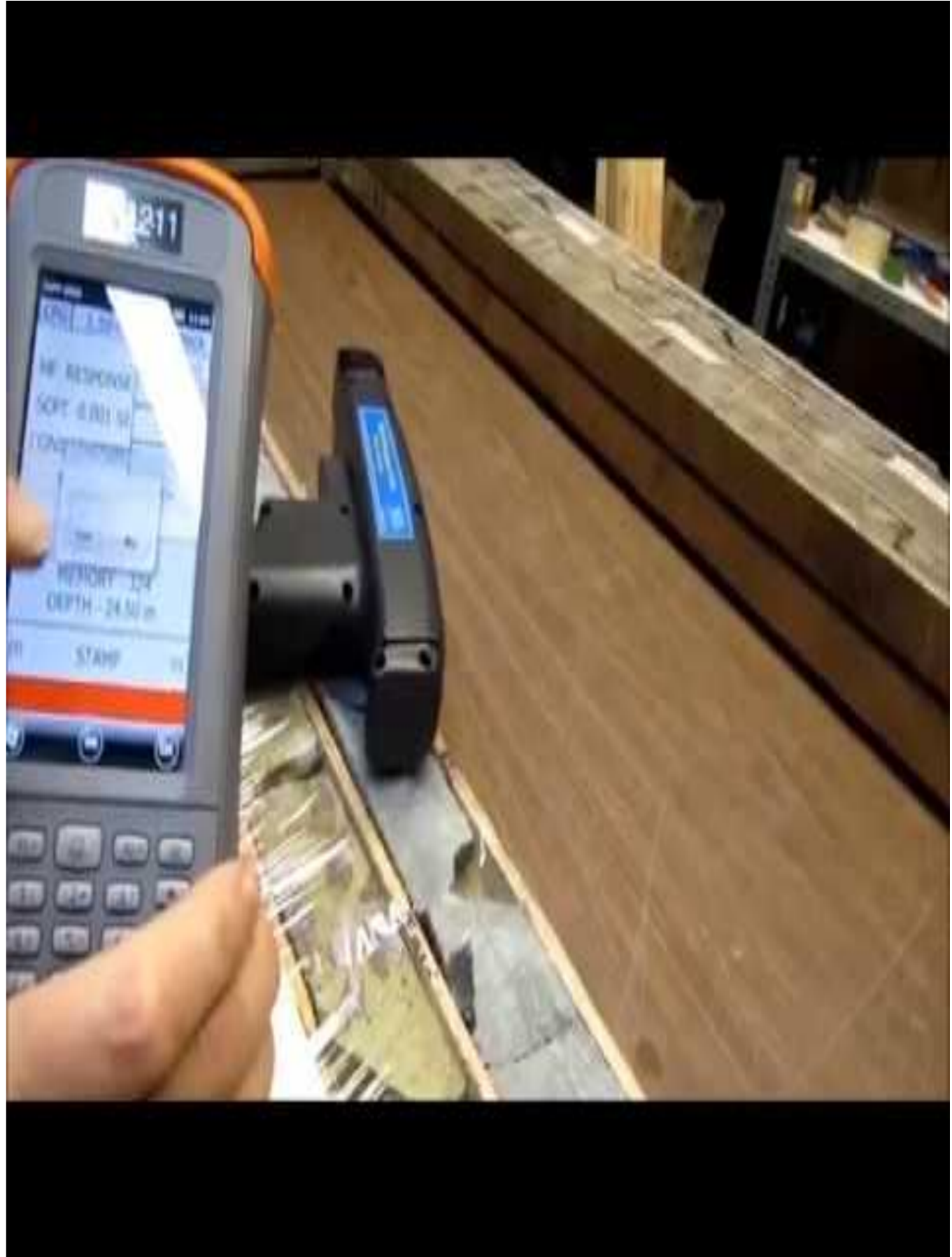
Figure 4: Mesure à l'aide de la sonde MPP Source: https://www.gdminstrumentation.com/fr/mpp-sonde
