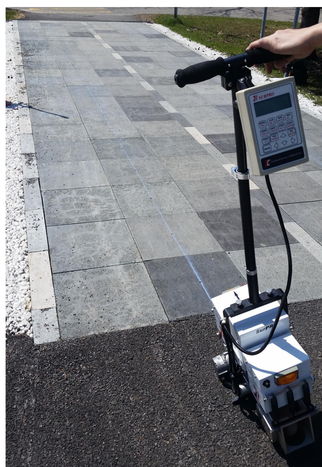
Figure 1: Prise de données avec le profilomètre sur des matériaux en étude.
