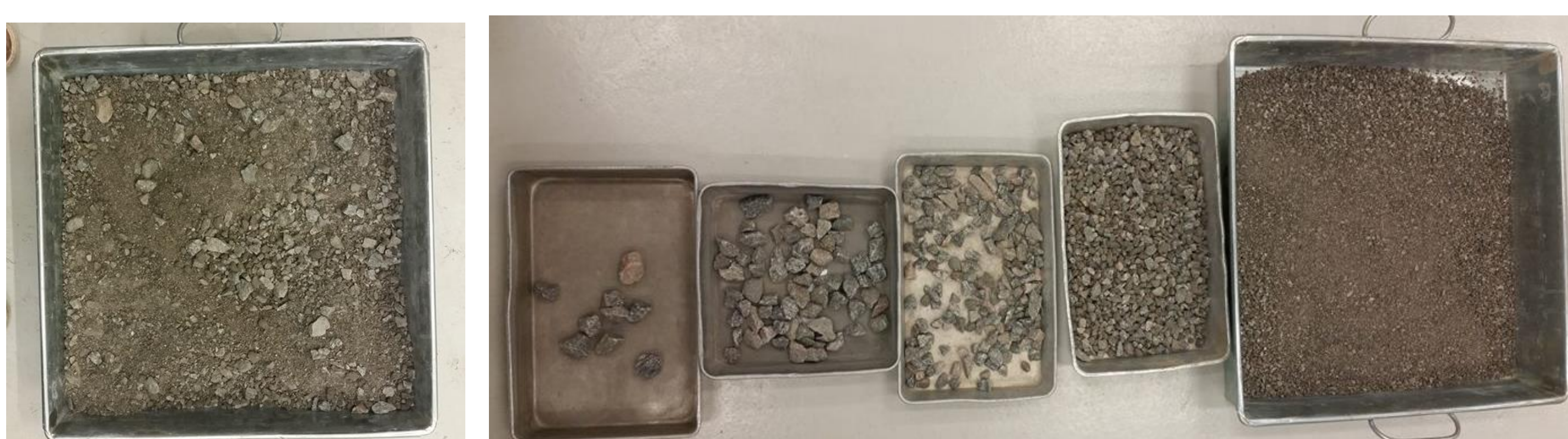
Figure 2 : Granulométrie de la fraction grossière d'un échantillon de sol. Sol original (à gauche) et séparé par tamisage (à droite).
