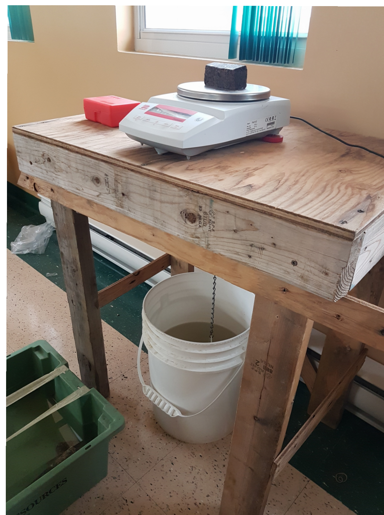
Figure 3 : Montage pour permettre la prise de mesure de densité des échantillons
