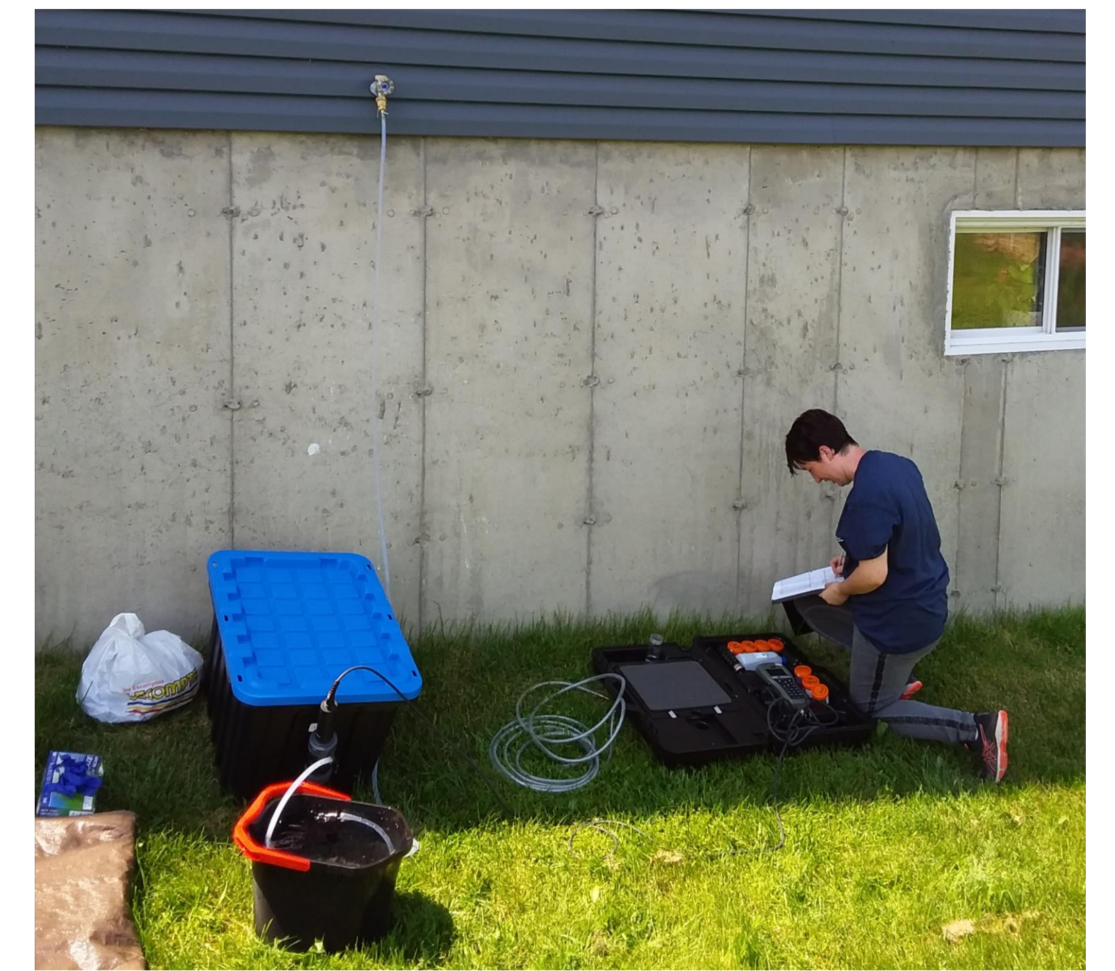
Figure 3 : Mesure des paramètres physicochimiques de l'eau avec une sonde multiparamètres
