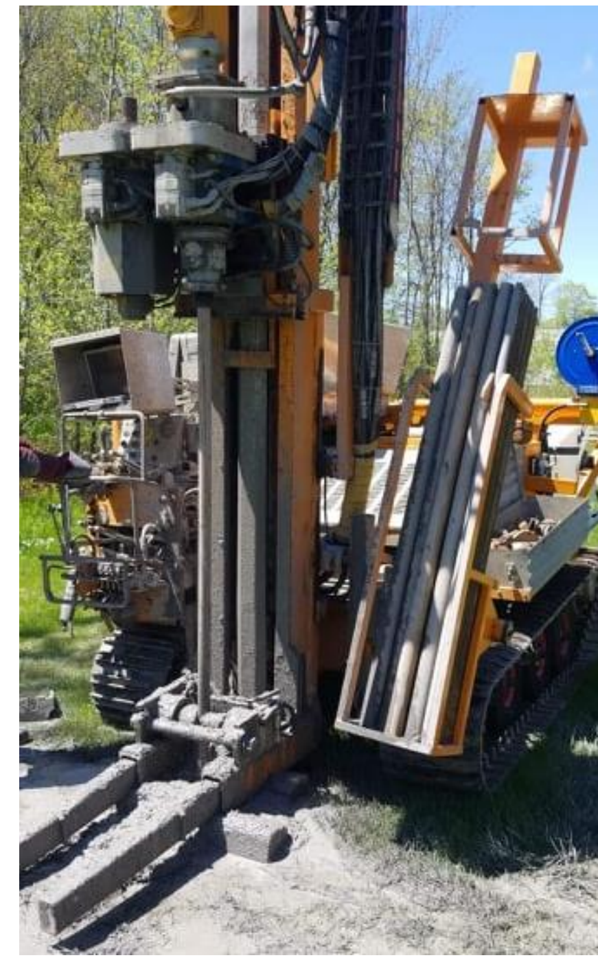
Figure 2 : Foreuse géotechnique de type Geotech 605D de l'INRS
