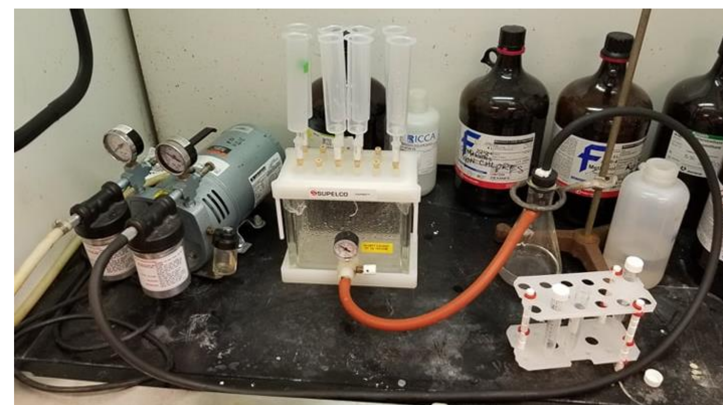
Figure 4 : Montage du système de preconditionnement des cartouches pour la spéciation de l'arsenic
