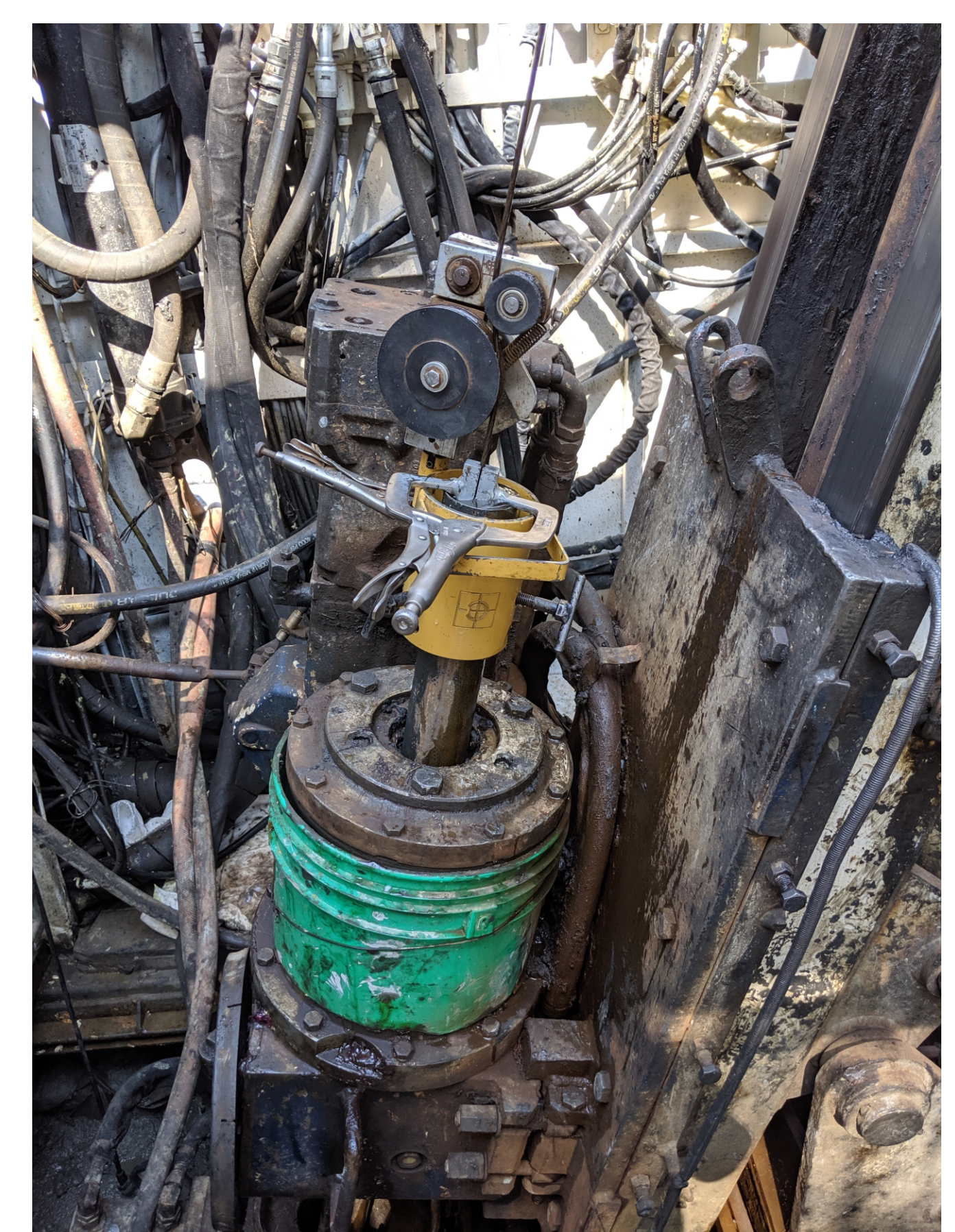
Figure 3, 4, 5 : Gyro, Gyro monté, prise de mesure dans le trou avec le gyro
