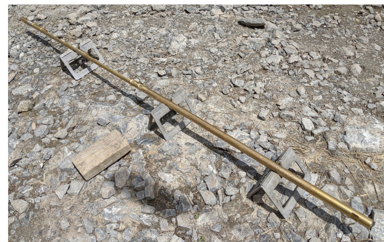
Figure 3, 4, 5 : Gyro, Gyro monté, prise de mesure dans le trou avec le gyro
