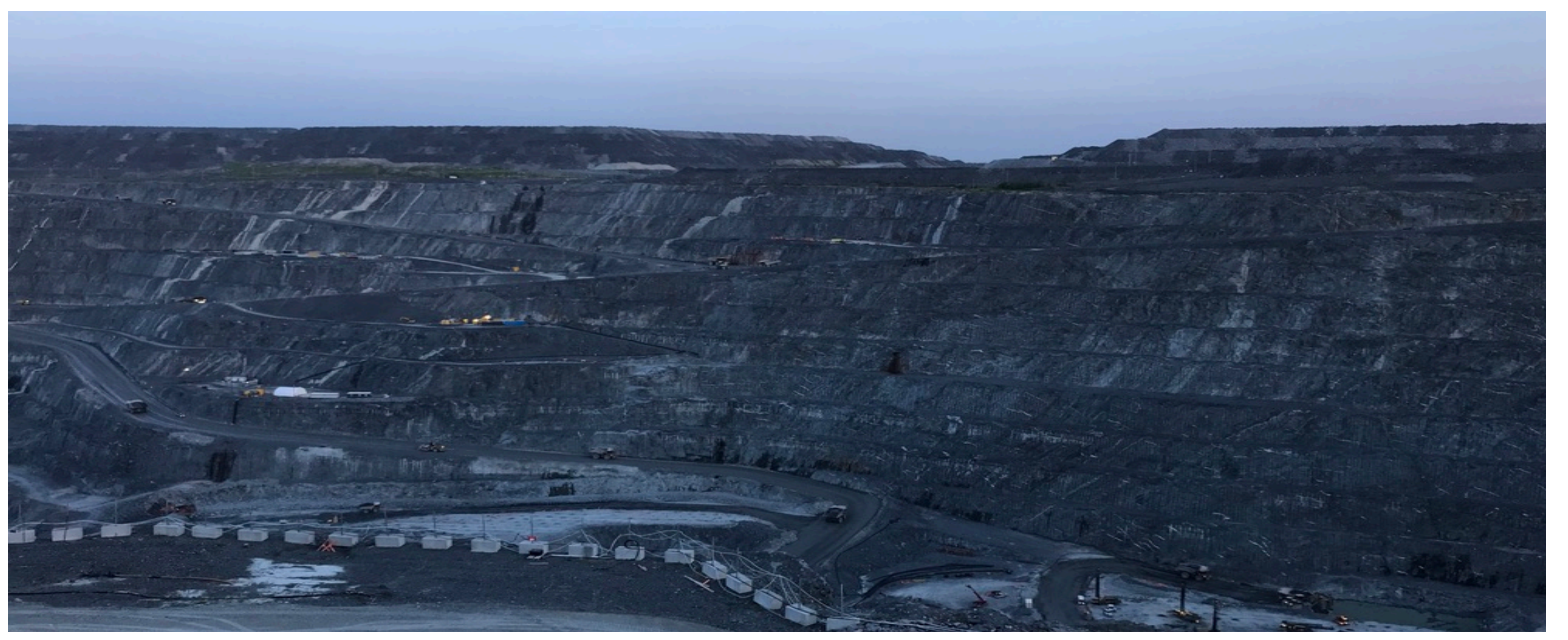
Figure 3 : Exemple d'un chantier dans la fosse Canadian Malartic. Celui-ci est délimité par des limites géotechniques et est identifié par des bornes rouges et de la peinture, à l'intérieur desquelles un travailleur doit être attaché à une ligne de vie pour y circuler.
