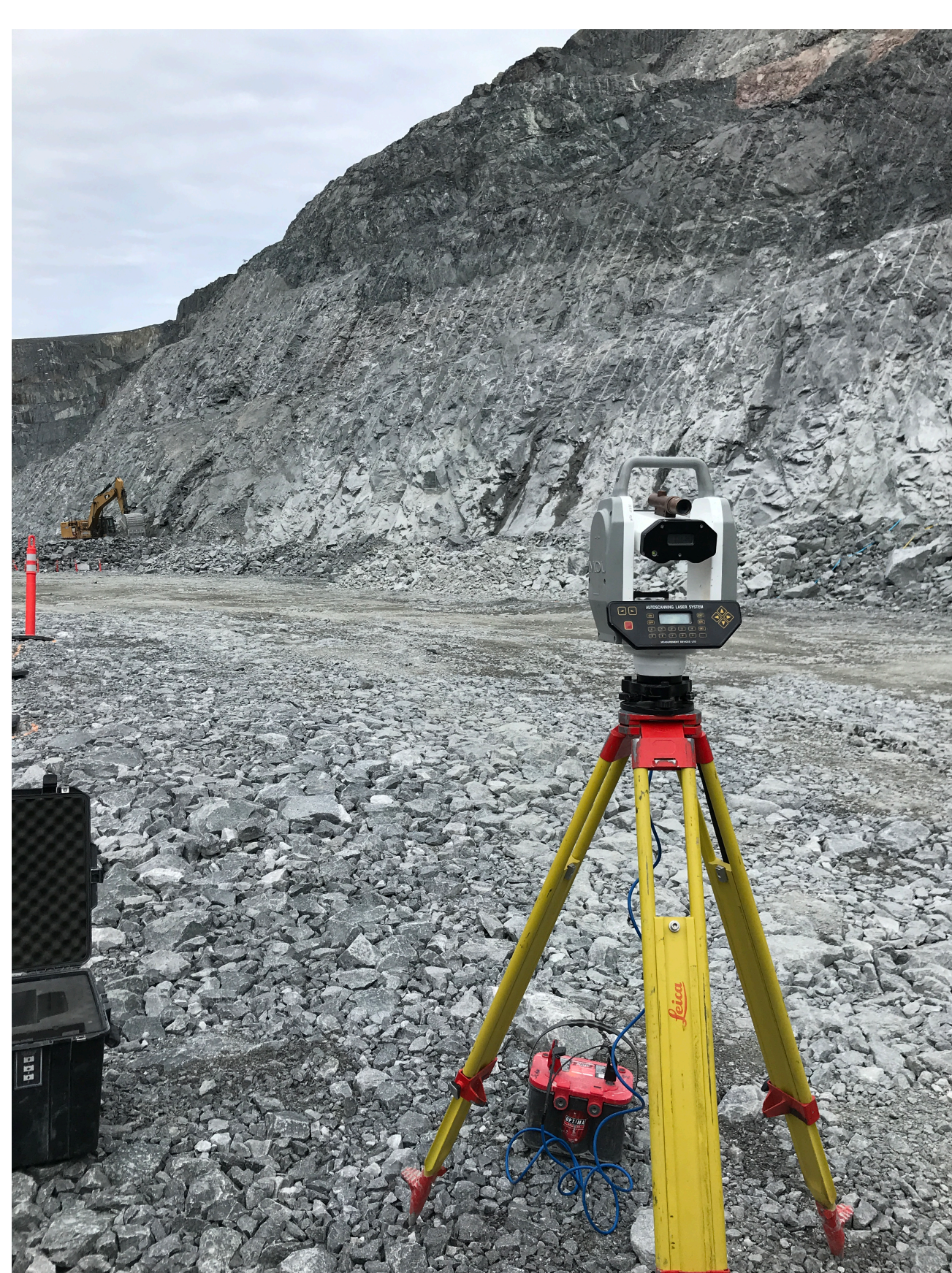
Figure 5 : Scanner MDL en cours d'utilisation pour scanner une partie du mur nord de la fosse Canadian Malartic
