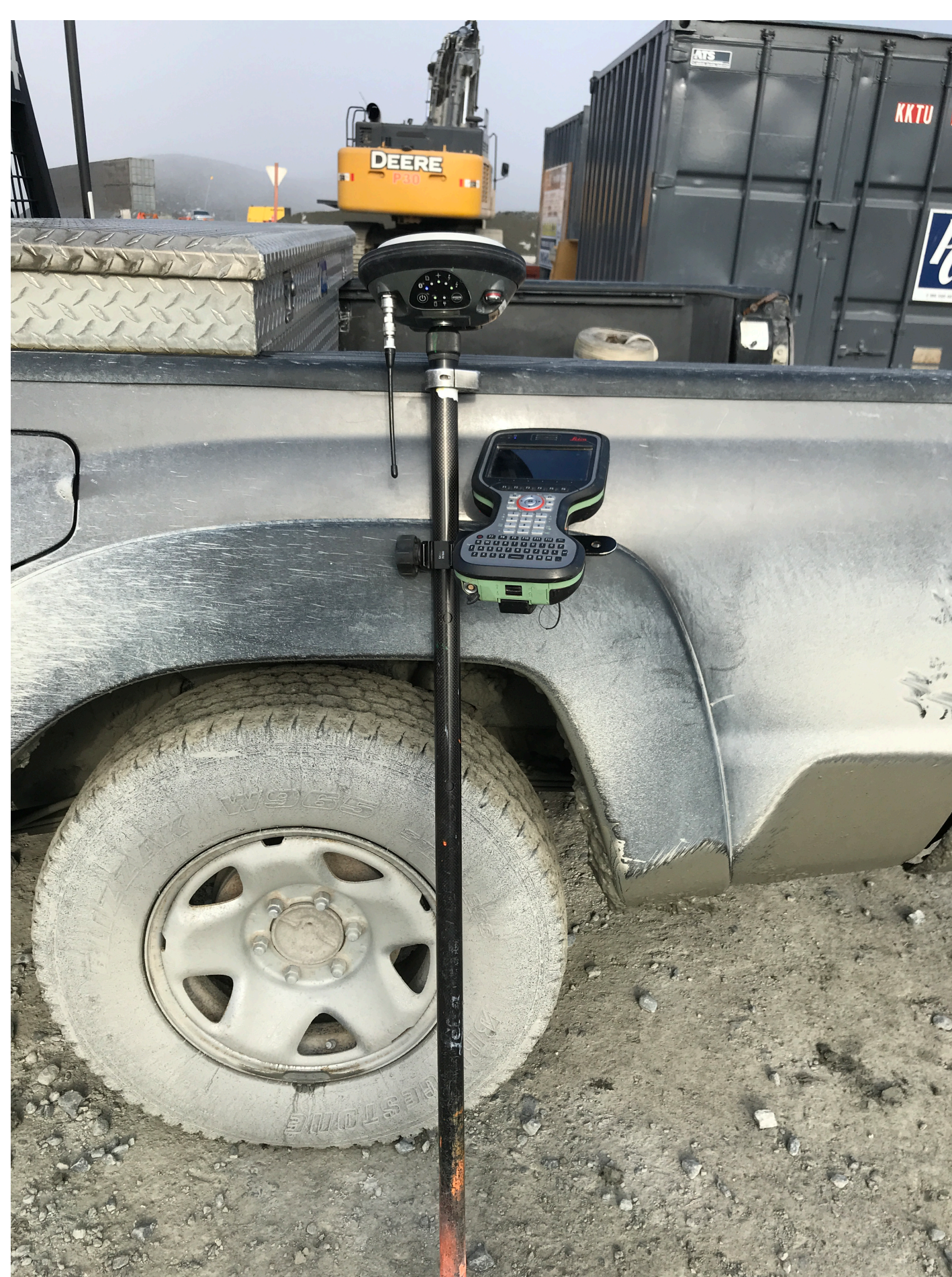
Figure 2 : Antenne et carnet GPS Leica pour la levée et l'implantation de points et de lignes.
