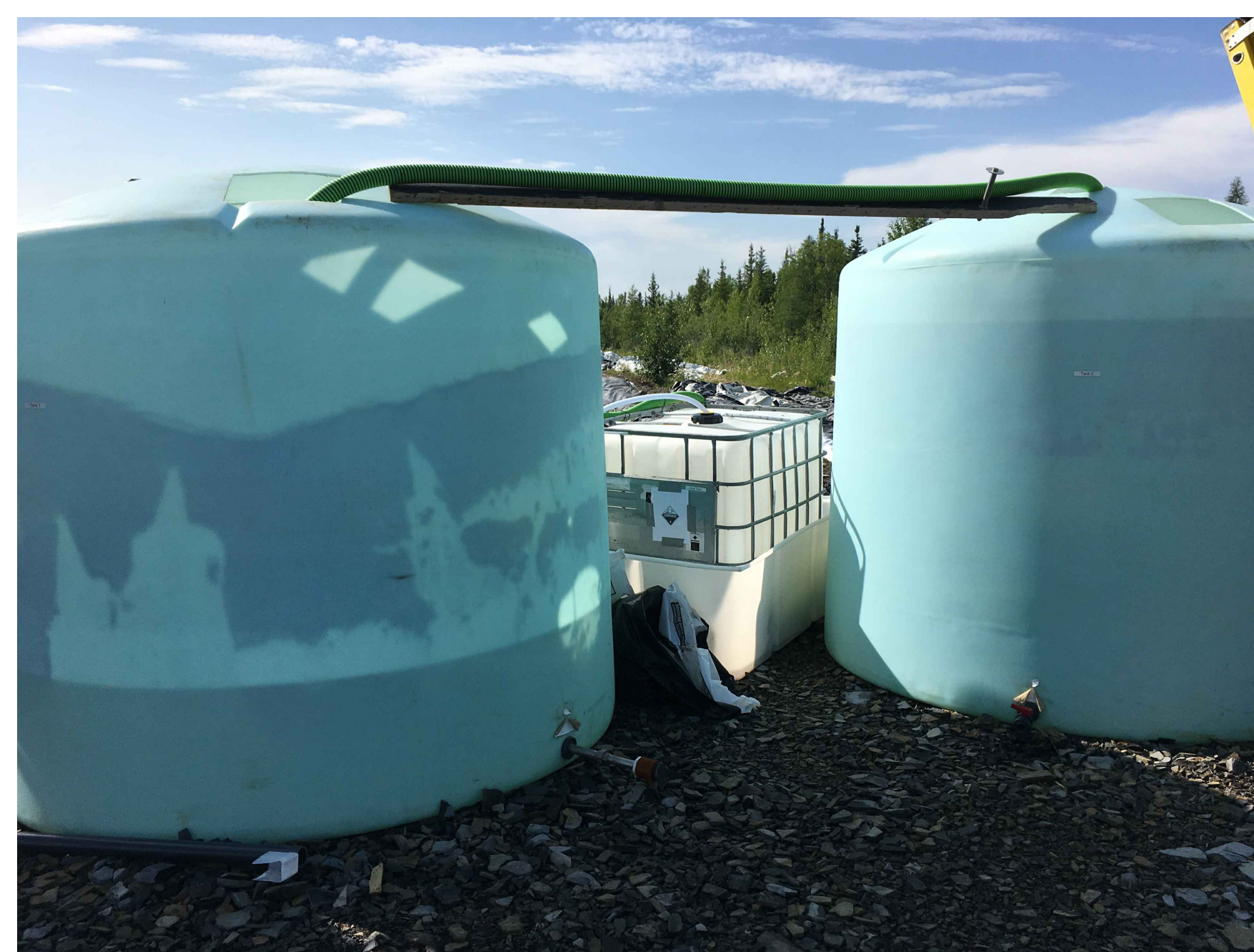
Figure 5: réservoir 1m3 d'acide et 2 réservoirs d'amendements dont l'un avec un précipité.
