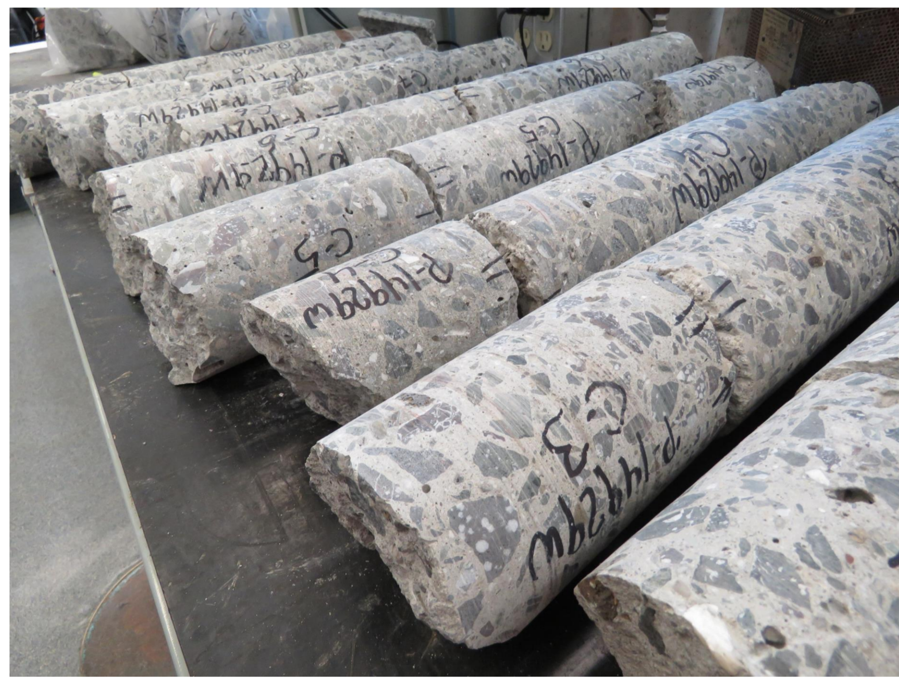
Figure 1 : Carottes extraites d'une dalle épaisse et prêtes à être testées, MTMDET, QC.
