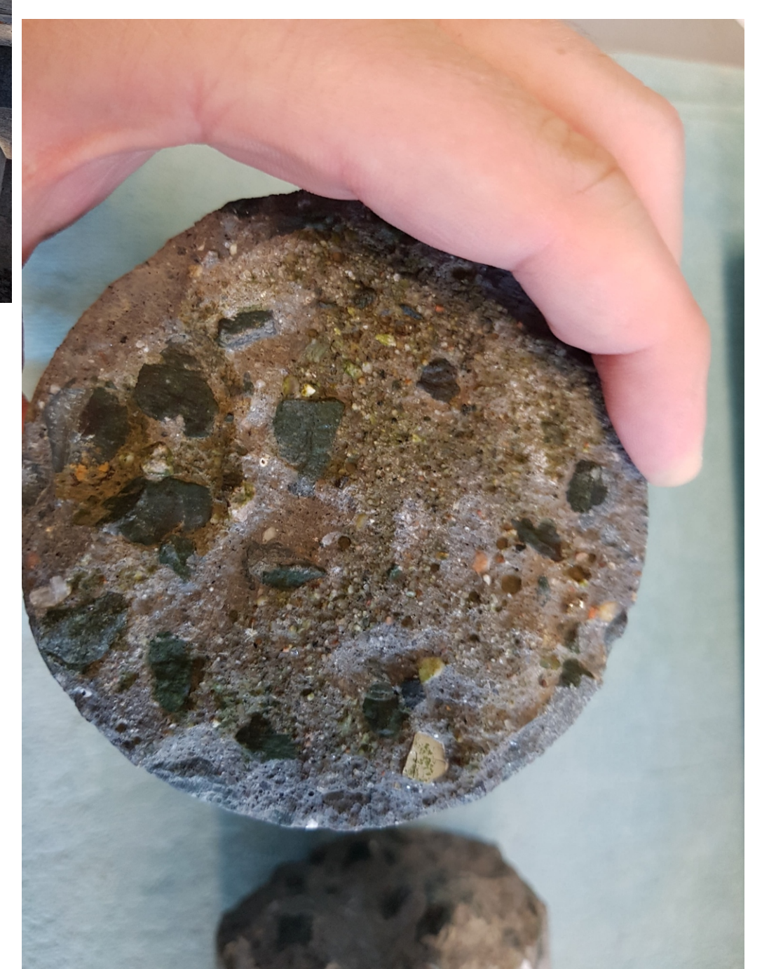
Figure 5 : Exemple d'écaillage et de pop-outs trouvés pendant une inspection visuelle de carotte.
