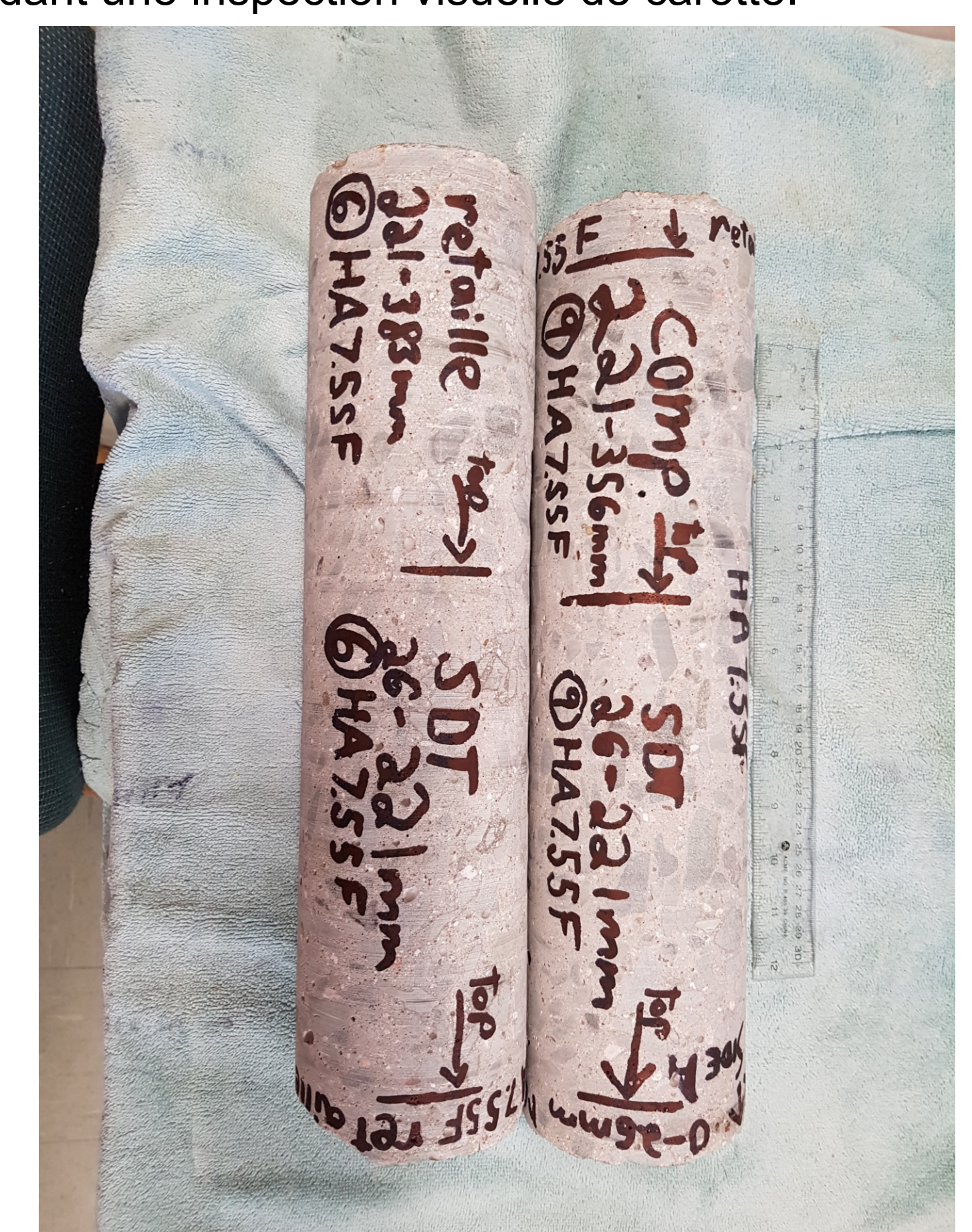
Figure 6 : Marques effectuées sur les carottes après l'inspection visuelle de ces dernières.
